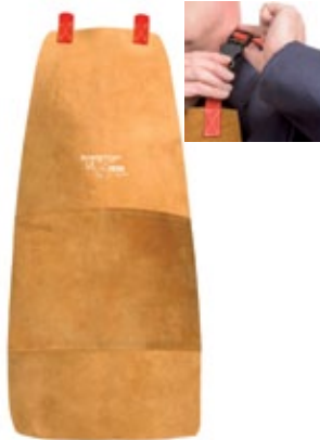
ST2022 sobre pedido DELANTAL CERTIFICADO EN 11611 Delantal certificado para soldadura, serraje marrón de primera calidad, espesor homogéneo. Refuerzo extra en la parte del vientre 57x30cm. Dimensiones 90x60 cm Embalaje: 1 ud.
